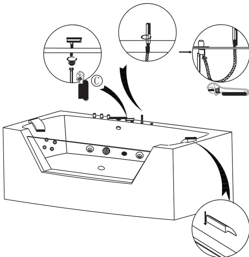
3. Réglez les pieds de baignoire horizontalement. Placer la baignoire au coin du mur, raccordez le siphon au trou d'évacuation et jointer avec du téflon. Laissez un espace entre la baignoire et la paroi et siliconer pour éviter le risque de fuite.
