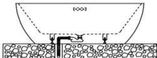
4. Após a instalação, teste a banheira enchendo-a com água. Verifique se está a escoar completamente e sem fugas. Se a resposta for positiva, a banheira foi instalada corretamente e está pronta para ser usada.
