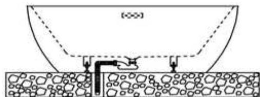
4. Dopo l'installazione, testare la vasca riempiendola d'acqua. Se scarica correttamente e completamente, la vasca è stata installata in maniera adeguata ed è pronta per essere utilizzata.
