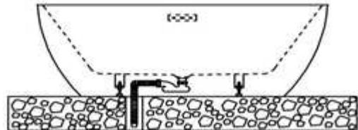
4. Test na de installatie of deze goed is uitgevoerd door de badkuip met water te vullen. Als het water volledig en naar behoren wordt afgevoerd is de badkuip correct geïnstalleerd en is hij klaar voor gebruik.
