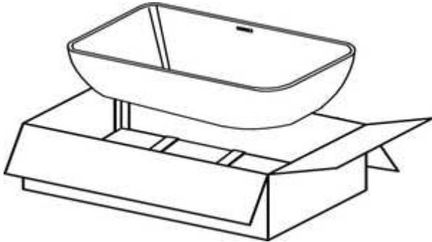
2. Zorg ervoor dat de vloer waar je de badkuip wil installeren vlak is. Zorg ervoor dat de badkuip stabiel staat door de hoogte van de pootjes af te stellen. Als je dit niet goed afstelt kan het water niet goed weglopen wat voor schade kan zorgen.
