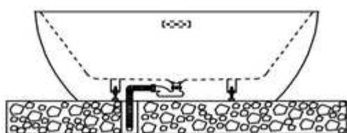
4. Testaa kylpyammetta asennuksen jälkeen täytämällä se vedellä. Amme on asennettu oikein ja valmis käytettäväksi, jos vesi valuu kunnolla ja kokonaan pois ammeesta viemäriin.
