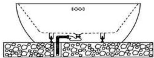
4. Après l'installation, veuillez tester la baignoire en la remplissant d'eau. Si elle se vide correctement et complètement, la baignoire a été correctement installée et prête à être utilisée.
