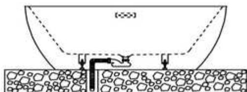
4. Efter installationen bör du testa badkaret genom att fylla det med vatten. Om det rinner ut ordentligt och fullständigt har badkaret installerats korrekt och är redo att användas.
