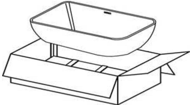
2. Stellen Sie sicher, dass der Boden, auf dem die Badewanne stehen soll, eben ist. Passen Sie die Höhe der Wannenbeine an, um die Standsicherheit der Wanne zu gewährleisten. Andernfalls kann das Wasser nicht richtig abfließen, wodurch das Modell beschädigt werden könnte.
