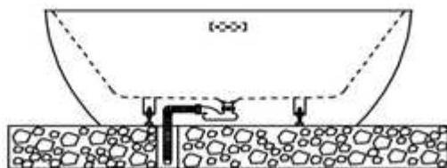
4. Nach dem Einbau sollte die Badewanne testweise mit Wasser gefüllt werden. Wenn das Wasser vollständig und problemlos abläuft, dann wurde das Modell korrekt installiert und kann benutzt werden.
