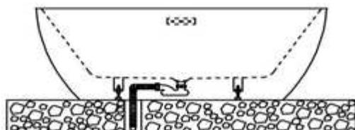
4. Po podłączeniu wannę prosimy o wlewanie do niej wody w celu przetestowania jej. Jeżeli woda poprawnie spływa, produkt został zamontowany prawidłowo i jest gotowy do użytku.
