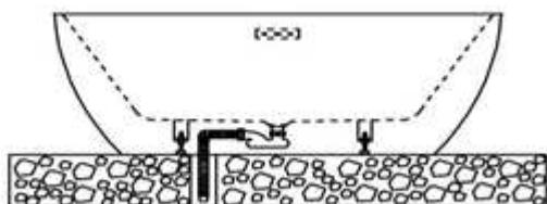
4. Una vez finalizado el proceso, llene la bañera con agua. Compruebe que el drenaje se está realizando de forma correcta, sin fugas. Si es así, la bañera ha sido instalada de forma correcta y está lista para su utilización.
