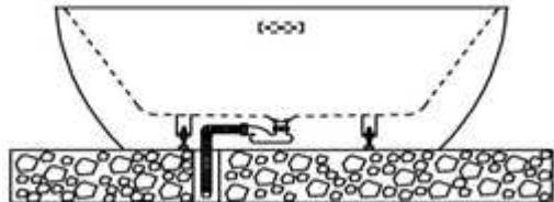
4. Po inštalácii vaňu otestujte naplnením vodou. Ak správne a úplne odtečie, vaňa bola správne nainštalovaná a pripravená na použitie.
