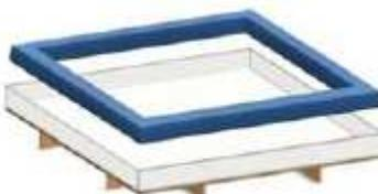
Placez maintenant le cadre en mousse dans la housse, assurez-vous que les bords extérieurs sont bien alignés au plancher.
