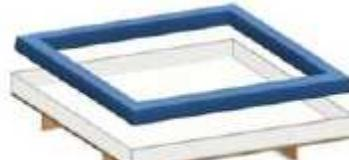
Pěnový rám namontujte do spodní části potahu matrace podél vnějších okrajů soklů.
