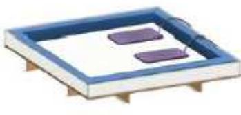
Legen Sie die Heizelemente hinein - beim Mono-System in der Mitte des Bettes, beim Dual-System an der rechten und linken Bettseite, leicht gegen das Fußende des Bettes.
