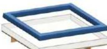
Umieść ramę z pianki w pokrowcu i ustaw ją wzdłuż brzegów płyty nośnej.
