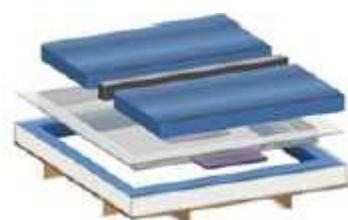
Colocar o separador térmico no meio (apenas para o Dual-System) e colocar os colchões de água no forro de segurança.
