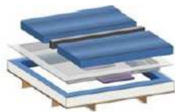
Legen Sie den Thermotrennkeil in die Mitte (nur beim Dual-System) und legen Sie die Wassermatratzen in die Sicherheitsfolie.
