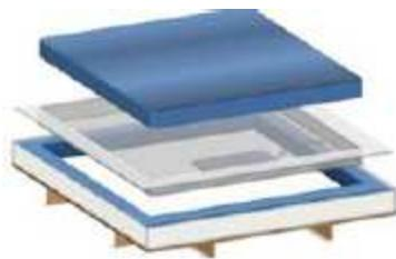
Coloque el forro de seguridad en el marco de espuma (las costuras deben estar hacia abajo).
