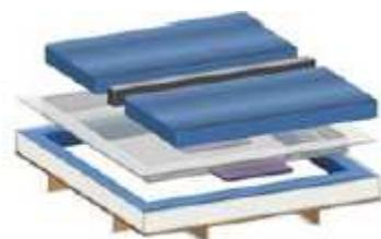
Placez le séparateur thermique au milieu (uniquement pour les matelas Dual), ensuite positionnez le matelas à eau sur le liner de sécurité.
