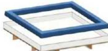
Stecken Sie den Schaumstoffrahmen in den Unterteil des Matratzenbezugs - genau entlang des Außenrands des Podests.
