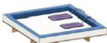
Colocar os elementos de aquecimento - no meio da cama para o Mono-System, e nos lados direito e esquerdo da cama para o Dual-System, ligeiramente em direção à extremidade dos pés da cama.
