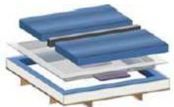
Umístěte tepelný oddělovač doprostřed (pouze pro duální systém) a vložte vodní matrace do bezpečnostní vložky.
