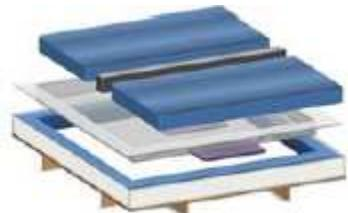
Helyezze a hőelválasztót középre (csak dual rendszer esetén), és helyezze a vízágymatracokat a biztonsági betétbe
