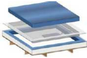
Vložte bezpečnostní vložku do pěnového rámu (švy by měly směřovat dolů).
