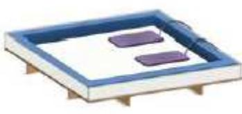
Plaats de verwarmingselementen in het midden van het bed (Mono-systeem) of links en rechts en iets meer richting het voeteneinde (Dual-systeem).
