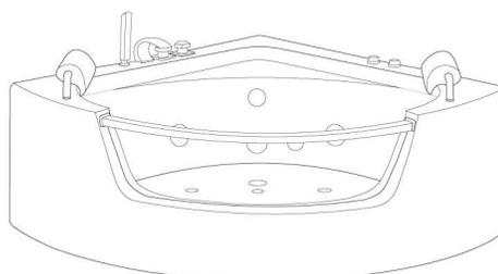
5. Ligue o cano de drenagem da banheira ao cano de drenagem de sua casa e ligue o cano de água da banheira ao ponto de fornecimento de água.
